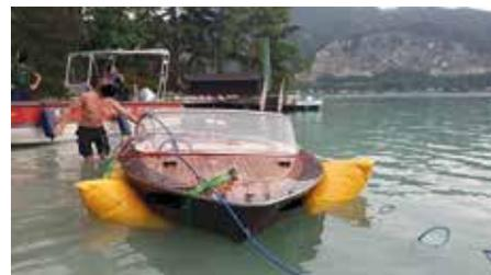
tels Hebeballonen geborgen und abgeschleppt werden, da es ohne diese Maßnahmen voll Wasser gelaufen und untergegangen wäre.
